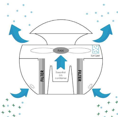
Der Ventilator saugt die Luft durch die unteren Öffnungen des Gerätes ein. Die Luft wird dank eines Partikelfilters des Typs E-11 von Pollen, Bakterien und anderen kleinen Partikeln bereinigt und gefiltert.
