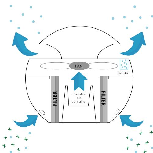
De ventilator trekt lucht aan door de openingen aan de onderkant van het toestel. De lucht wordt gereinigd dankzij een partikel filter type E11 die pollen, bacteriën et kleine deeltjes tegenhouden.
