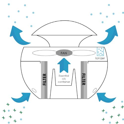
Viften trekker luft gjennom åpningene i enheten. Luften blir renset gjennom et partikkelfilter av typen E11 som fjerner pollen, bakterier og små partikler. Lukt er fjernet av det aktiverte karbonsjiktet på filteret.
