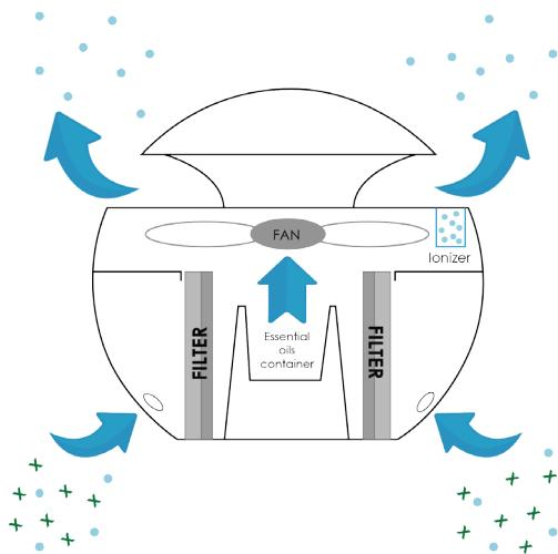
L'aria viene aspirata attraverso le aperture situate sotto l'apparecchio e viene purificata grazie al filtro antiparticelle di tipo E11 che trattiene polline, batteri e particelle ultrasottili.
