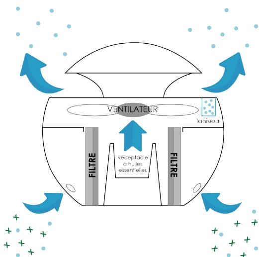
Le ventilateur aspire l'air par les ouvertures situées sous l'appareil. L'air est purifié grâce à un filtre à particules de type E11 qui retient pollens, bactéries et petites particules.
